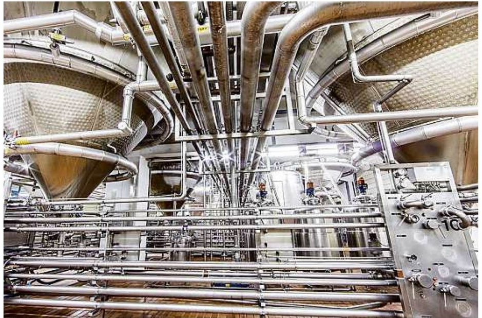
Braukessel in Puntigam: Deren Wärme wird abgeführt und ans angrenzende Brauquartier geliefert
